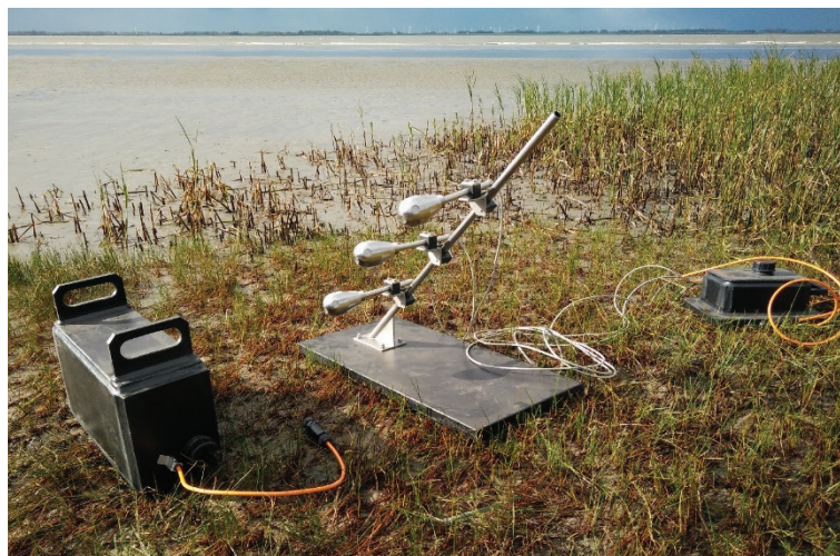
Abbildung 1. Bild des neukonstruierten Messsystems Watt-SST mit Austausch-Akku, Messrechner und Sensorgestell zur Quantifizierung von Spannungen
